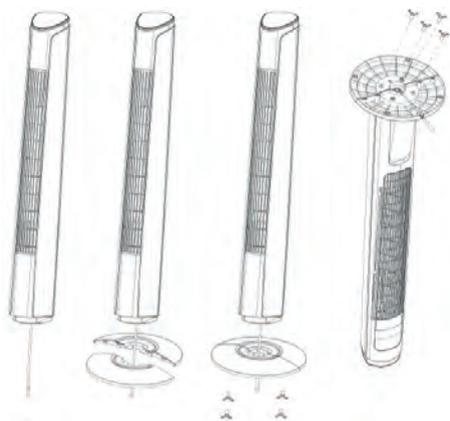
Le socle (4 et 5) de la tour vient en deux parties qui se fixeront très facilement autour de la base de l'appareil. Une partie du socle (4) devra être placée à l'avant de la base de l'appareil, et la seconde partie du socle (5) – celle avec une ouverture sur l'extérieur afin de faire sortir le câble électrique (6) – devra être placée à l'arrière.
